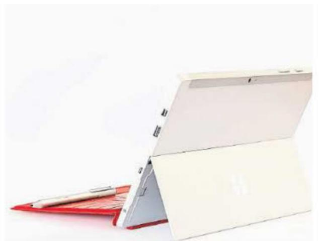
Die Rückenstütze lässt sich in drei Stufen ausklappen und verschwindet im Tablet-Betrieb ganz in der Rückseite. (Foto: Microsoft)
